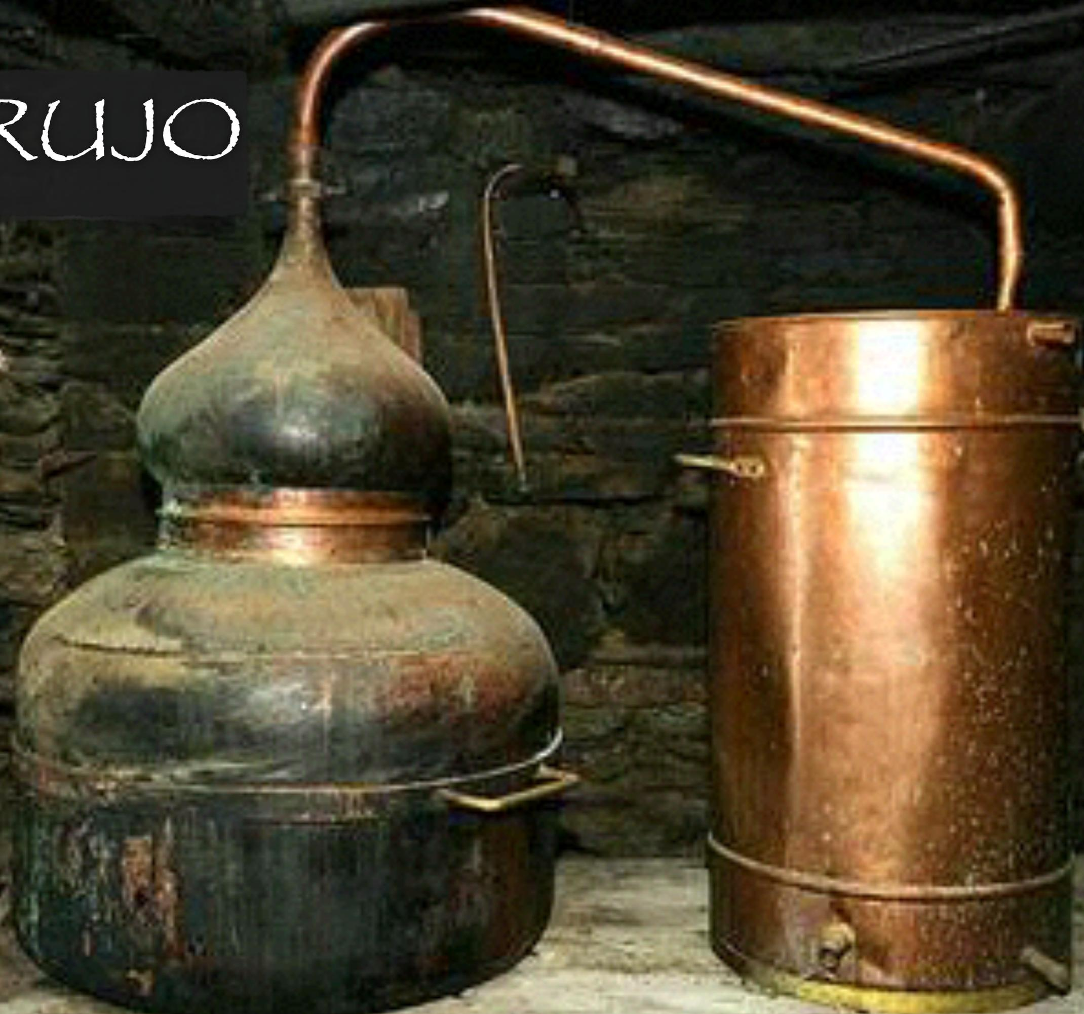
b) **montera**, tapa de la olla que recoge el vapor llevándolo hasta el refrigerante a través de un tubo
